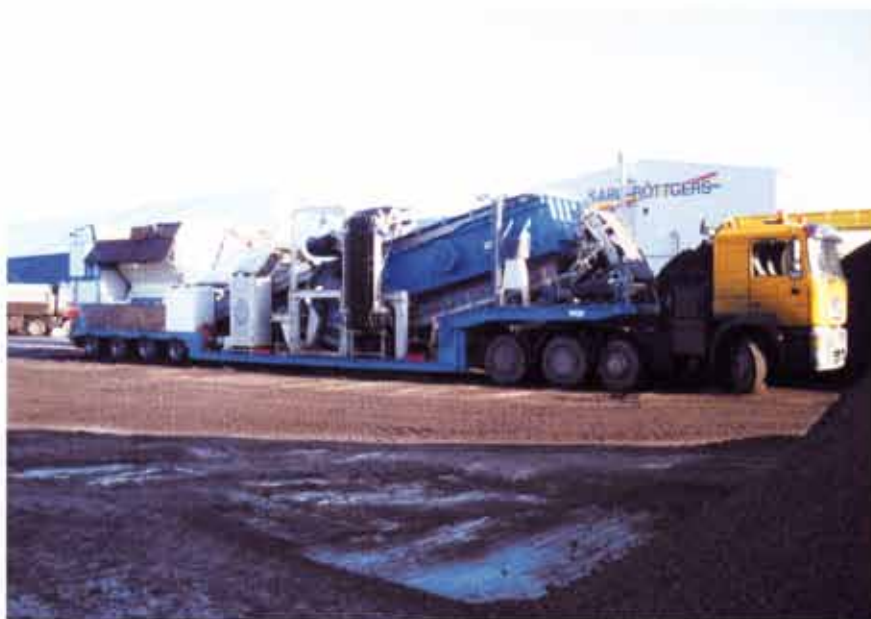
Die Aufbereitungsanlagen werden per Sattelzugauflieger und eigenen Zugmaschinen transportiert
